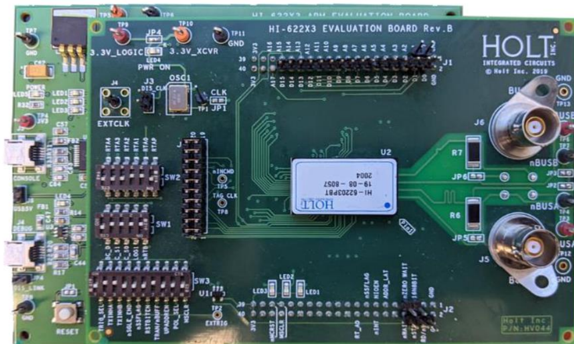
図 1 HI-62203 評価ボード、ARM Cortex MCU ボード上に設置
